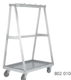
Construction en aluminium. Charge maxi: 600 kg. 4 roues: 2 fixes, 2 pivotantes, à chape acier électrozingué Ø 160 mm (chariot petit modèle), Ø 200 mm (chariot grand modèle).
